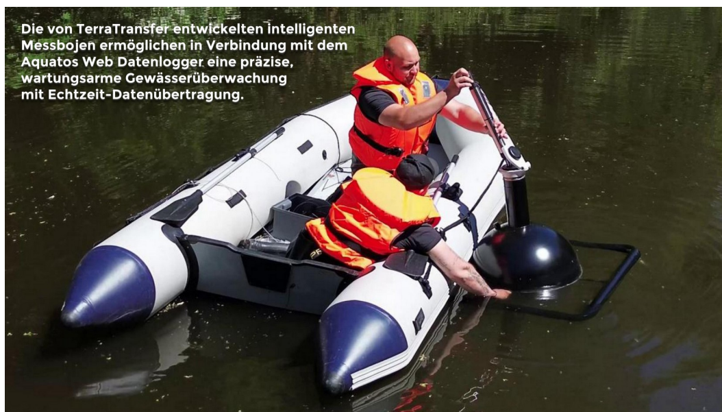
Figur 6: Utsättning av bojen för grunt vatten från en gummibåt; flytväst är obligatoriskt.
