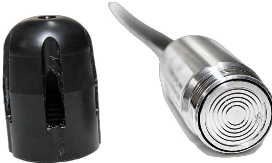
Figur 3: Piezotrycksensor typ 0312, lasersvetsad mätcell i rostfritt stål med avtagbar sensorkorg. Den oljefyllda tryckcellen i AISI 316Ti syns när korgen har tagits bort.
